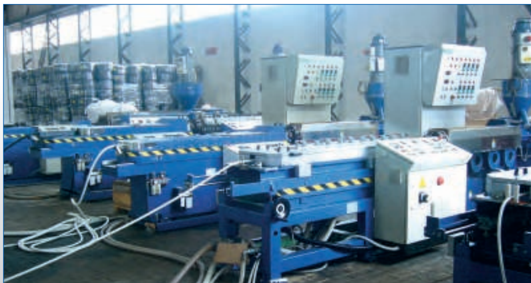
Atelier de production de gaine annelée dans l'usine d'Ancona
