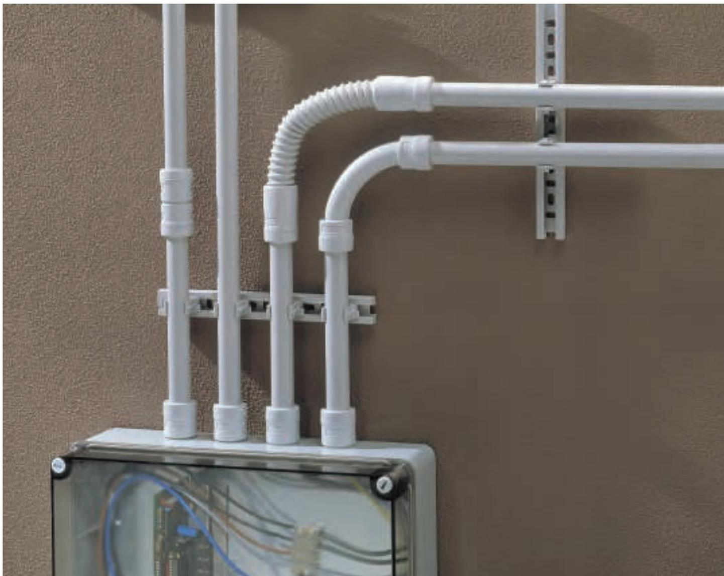
Les systèmes de raccords e@system, brevetés, représentent une solution sûre et définitive avec un indice de protection IP67 sur l'intégralité de la gamme. L'anneau interne de la garniture a une forme exclusive qui permet d'avoir un degré de dilatation élevé afin de s'adapter aux variations de diamètre des tubes rigides et garantir une tenue parfaite, même dans la durée. L'effort d'insertion est particuliè-
