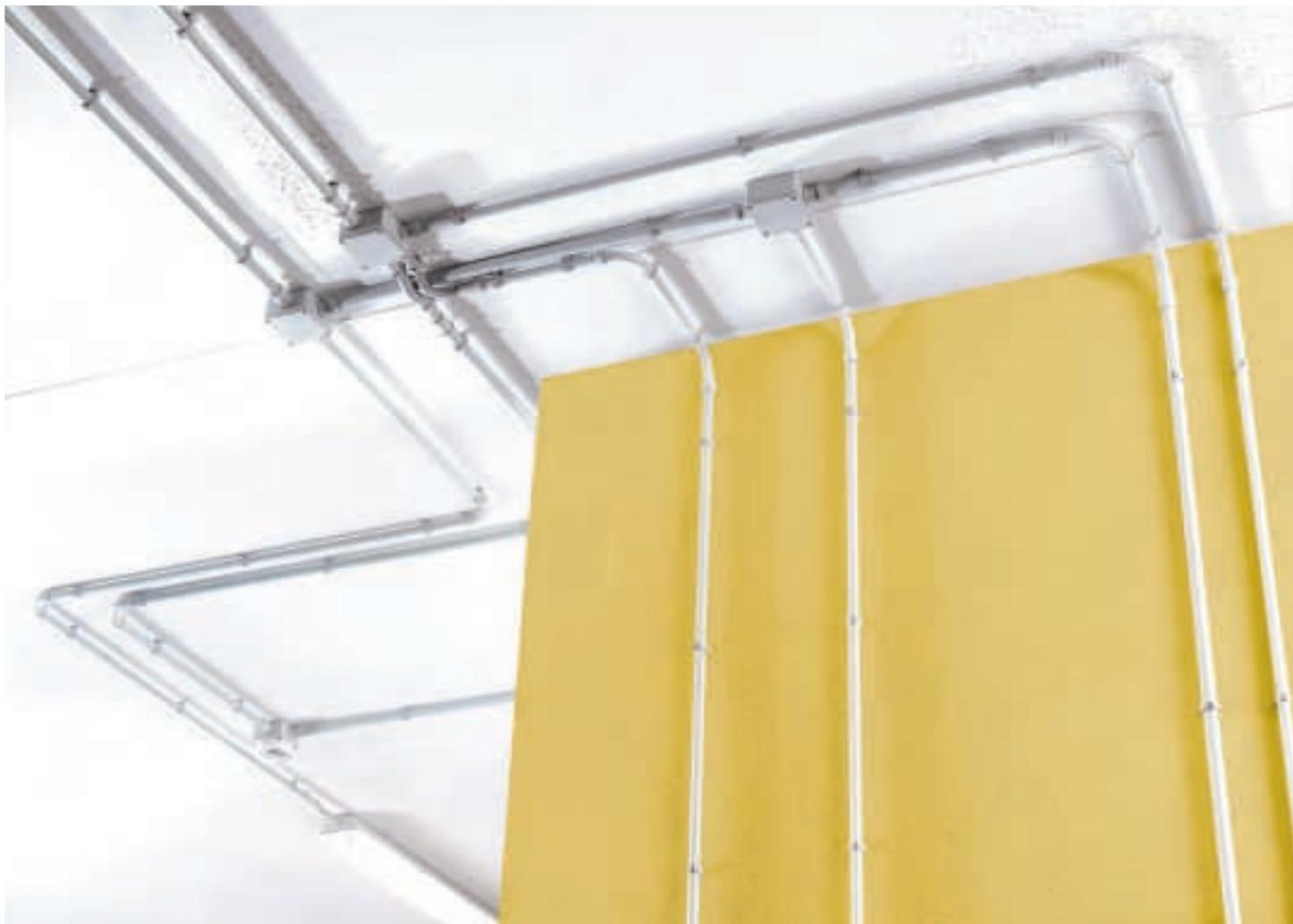
Les systèmes de tubes et accessoires comprennent des tubes rigides lisses et tulipés en technopolymère autoextinguible à base de PVC rigide et les nouvelles versions en technopolymère sans halogène conformes aux normes EN 50267-2-1, EN 50267-1-2, idéales pour des installations dans des lieux publics, des galeries, des théâtres, où on a la présence de personnes dans des environnements clos.
